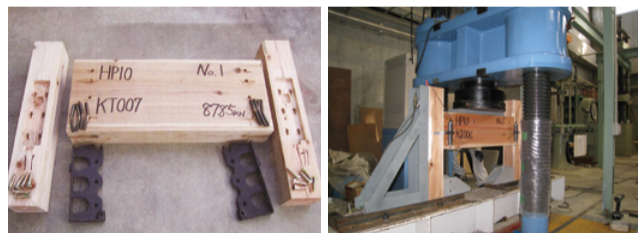
ウッドテック金物では杉ムク材を使って、最大荷重87kNでも破壊・割れが起こらない。
